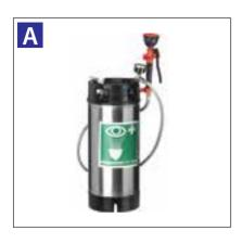
La doccia di soccorso portatile è ideale per il primo lavaggio di occhi, viso e mani in caso di contatto accidentale con prodotti chimici o aggressivi. Strutturata per essere facilmente trasportabile, consente l'accesso immediato ad una fonte di acqua corrente. La doccia portatile EASY SHOWER è dotata di un fusto inox da 18 I con doccietta estraibile, manometro e valvola di sicurezza per il sovraccarico di pressione.
