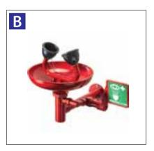
La doccia di soccorso fissa è ideale per il primo lavaggio degli occhi in caso di contatto accidentale con prodotti chimici o aggressivi. La doccia DOUBLE SHOWER è dotata di due erogatori lavaocchi montati su una vaschetta in ABS resistente alla corrosione. Gli erogatori spruzzano sia acqua nebulizzata sia getti d'acqua convergenti. Da applicare a parete.
